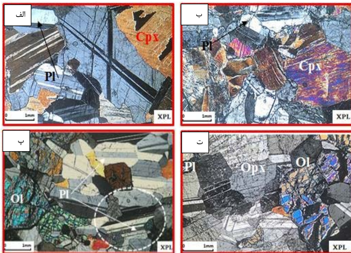
شکل ۹ تصاویری میکروسکوپی از گابروهای، مجموعه افیولیتی دشت سمسور: الف) پلاژیوکلاز (Pl) دانه درشت با ماکل چندریخت و کارلسباد، کلینوپیروکسن (Cpx)، ب) وجود پلاژیوکلاز (Pl) و کلینوپیروکسن (Cpx) که هر دو در حال دگرسان شدن هستند، پ) بلورهای سالم و دانه درشت پلاژیوکلاز (Pl) با ماکل چندریخت، کارلسباد و کانی دانه درشت اولیوین (Ol) در اولیوین گابرو، ت) کانی پلاژیوکلاز (Pl) به نسبت سالم، دارای ماکل چندریخت و کانی‌های اولیوین (Ol) و ارتوپیروکسن (Opx) در ترتولیت‌ها (همه تصاویر در نور قطبیده متقاطع (XPL) با بزرگ‌نمایی 40X تهیه شده‌اند).
