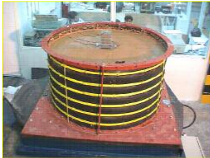
شکل ۱۸- نمایی از آزمایشهای اندرکنش خاک-سازه منفرد
