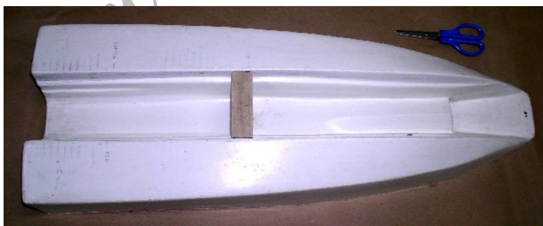
شکل ۷- مدل هیسوکت با آرایش تک هیدروفویلی
