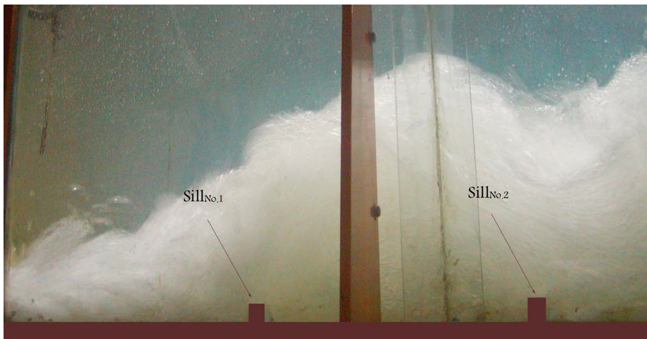
شکل ۲۵- چگونگی تشکیل جریان در حالت ترکیبی از دو دیواره s_1 = 20 \text{ mm} و s_2 = 30 \text{ mm} ( Q = 61/83 \text{ L/sec} )
