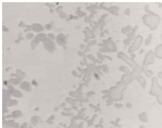
شکل ۳- خوشه‌ای شدن ذرات کاربیدی در نمونه Fe-10%Ti-3%C ریخته‌گری شده به روش گریز از مرکز در قالب سرامیکی پیش‌گرم شده در دمای ۴۰۰ درجه سانتیگراد، در حالت اچ نشده
