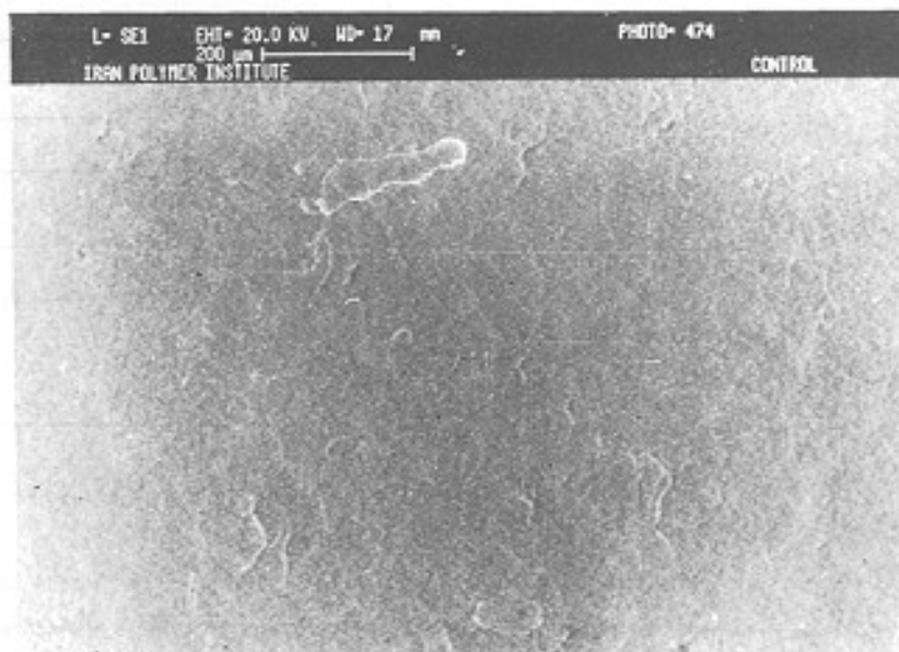
شکل ۵- عکس SEM سطح مقطع شکست نمونه کنترل با بزرگنمایی ۱۰۰.
