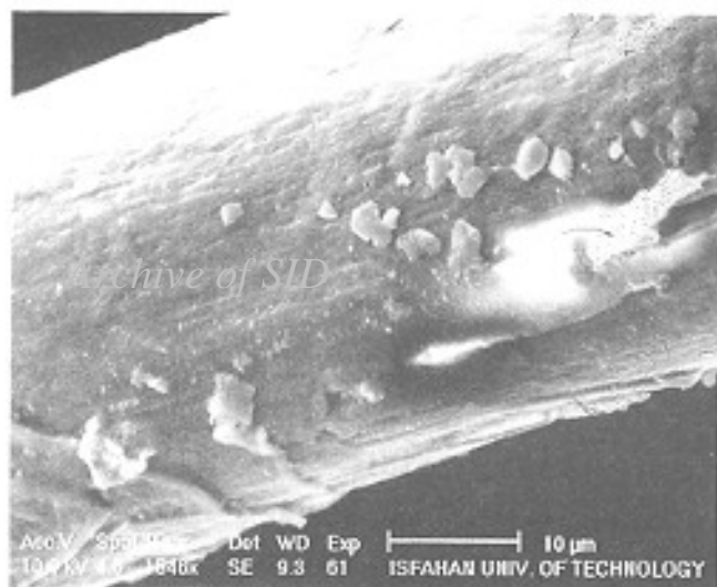
شکل ۱۲ - (الف) پشم عمل آوری شده با آنزیم به مدت ۲۴ دقیقه و (ب) شکاف ایجاد شده روی همان پشم.
