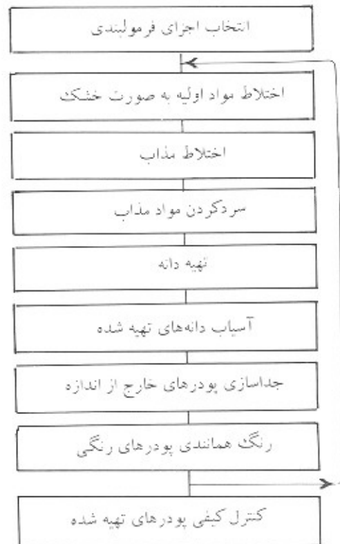
شکل ۲ - نمودار جریان تهیه پوششهای پودری به روش اختلاط مذاب.
