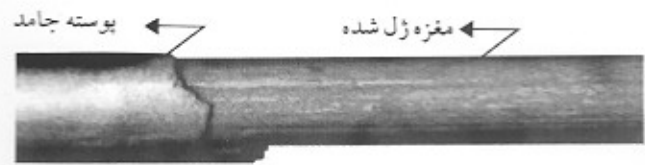
شکل ۱۱- پدیده پخت پوسته‌ای ناشی از پخت غیریکنواخت قطعه درون قالب.
