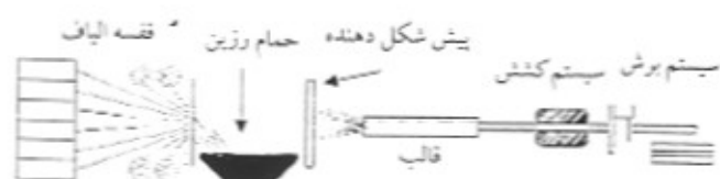
شکل ۱- نمایی از فرایند پولتروژن
