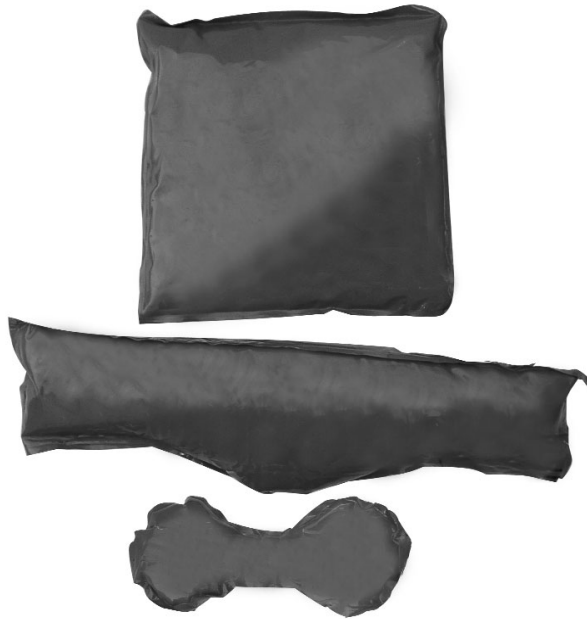
شکل ۴ - نمونه‌هایی از بسته‌های گرمایی ساخته شده در این طرح با شکلهای مختلف برای استفاده در قسمتهای مختلف بدن.
