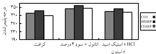
شکل ۵ - رابطه درجه پلیمر شدن آلفا سلولوز بدست آمده با نوع خمیرسازی و نوع مراحل رنگبری در پیش آبکافت با سولفوریک اسید.
