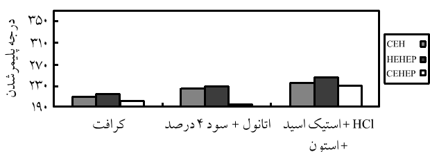
شکل ۶ - رابطه درجه پلیمر شدن آلفا سلولوز بدست آمده با نوع خمیرسازی و نوع مراحل رنگبری در پیش آبکافت با پتاسیم هیدروکسید.
