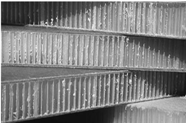
شکل ۲ - ساختار سانداویچی ساخته شده نهایی.
