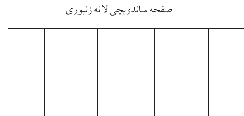
(الف) ساختار ساندویچی لانه زنبوری گرمانرم قبل از اعمال فشار.
