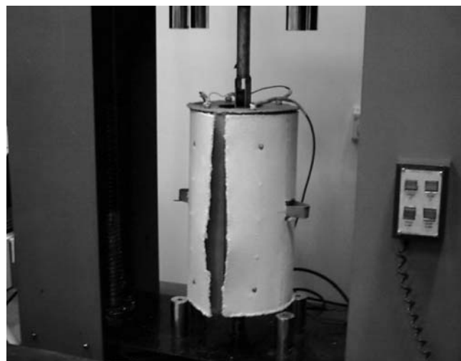
شکل ۴ دستگاه کشش مجهز به کوره فلزی برای کشش گرم.
