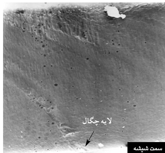
شکل ۶ تصویر SEM از مقطع عرضی غشای EVA با ۱۸ درصد وینیل استات با بزرگنمایی ۱۰۰۰.
