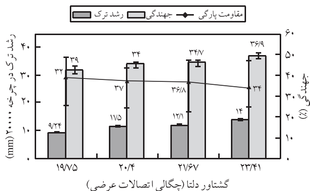
شکل ۳ - اثر چگالی اتصالات عرضی بر مقاومت در برابر رشد ترک، مقاومت پارگی و جهندگی آمیخته NR/BR/SBR در نسبت گوگرد به شتاب دهنده ۲/۲۲.
