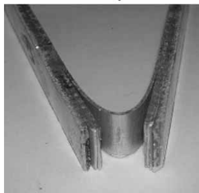
شکل ۱۲ - نمونه بلند شکسته شده B در دستگاه J ۱۵۰.
