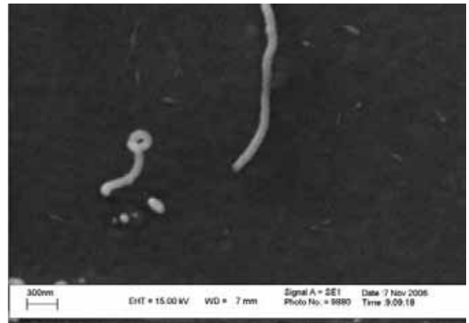
شکل ۱۳ - تصویر SEM از پیوند فصل مشترک نانولوله های کربنی با زمینه اپوکسی در نانوکامپوزیت EP9/0.6CNT.
