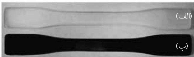
شکل ۳ - تصویر نمونه‌های: (الف) فاقد نانولوله و (ب) دارای ۰/۶ درصد وزنی نانولوله.
