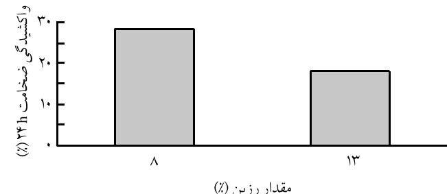
شکل ۱۲ - اثر مستقل مقدار رزین بر واکشیدگی ضخامت ۲۴ h تخته های ساخته شده از رزین AESO.
