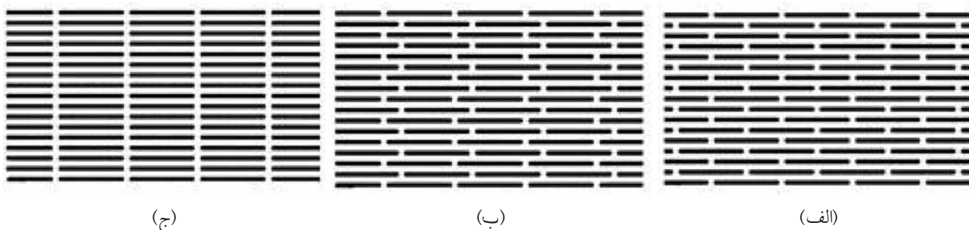
شکل ۱۰ - طرح کلی مدل ها برای ضرایب روی هم رفتگی مختلف: (الف) ۱، (ب) ۰/۵ و (ج) ۰.
