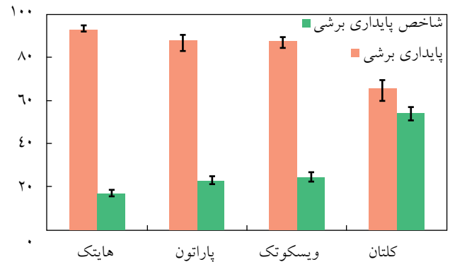
شکل ۱۲- مقایسه پایداری برشی و شاخص پایداری برشی محلول های پلیمری پس از فرایند برش مکانیکی.
