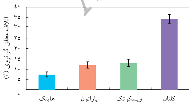
شکل ۱۱- مقایسه اتلاف مطلق گرانروی محلول‌های پلیمری پس از فرایند برش مکانیکی.
