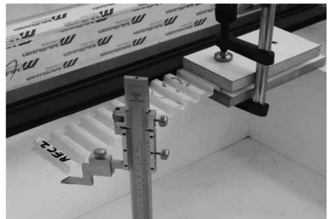
شکل ۱۹- اندازه‌گیری تغییر شکل انتهای ورق موج‌دار در اثر وزن آن.
