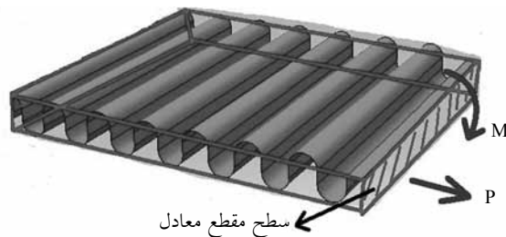
شکل ۵- اعمال بارگذاری به ورق موج‌دار.
