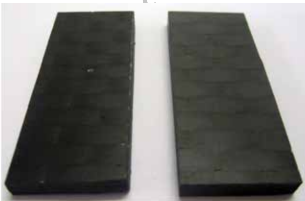
شکل ۱۴ - قطعات کامپوزیتی ساخته‌شده برای آزمون شیارزنی.
