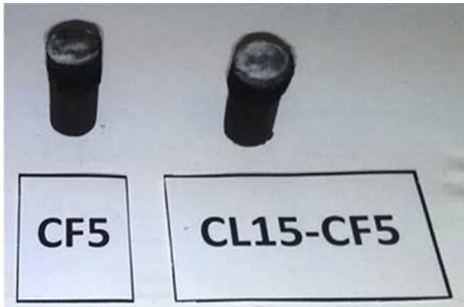
شکل ۴- تصویر نمونه‌های کامپوزیتی و نانو کامپوزیتی پس از اعمال شعله اکسی استیلن.
