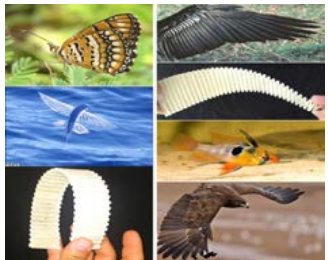
شکل ۱- ساختار موج‌دار بال‌های طبیعی و نمونه‌های کامپوزیتی [۱].
