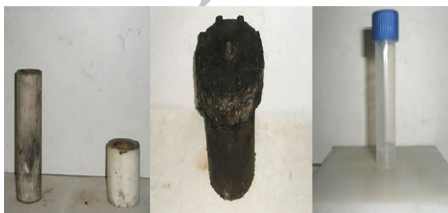
شکل ۲- (الف) قالب پلی‌پروپیلنی، (ب) اتوکلاو و (ج) قالب تفلونی.
