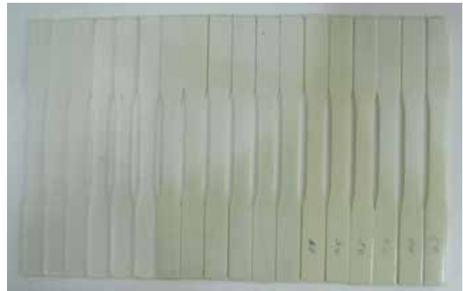
شکل ۴- نمونه‌های دمبلی شکل اپوکسی-نانوذرات پس از قالب گیری. روش قالب گیری در شکل ۴ نشان داده شده‌اند.
