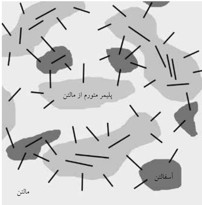
شکل ۶- الگوی ساختار قیر-نانو خاک رس-پلیمر.
