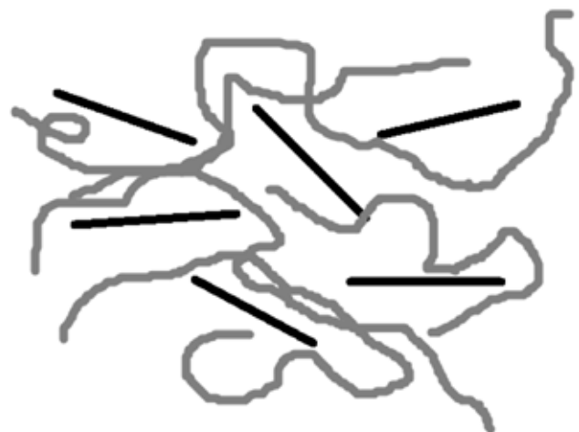
شکل ۵- الگوی وجود زنجیرهای پلیمر میان صفحه‌های نانو خاک رس.
