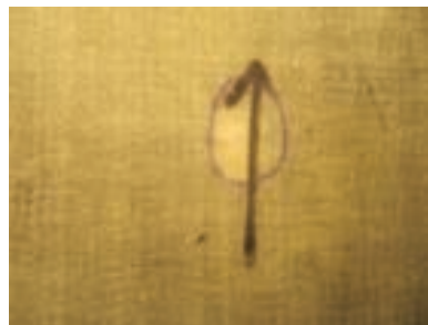
شکل ۹- شکل خرابی نمونه‌های ساندویچی با رویه‌های: (الف) آلومینیمی و (ب) کامپوزیتی در تکیه‌گاه ساده.
