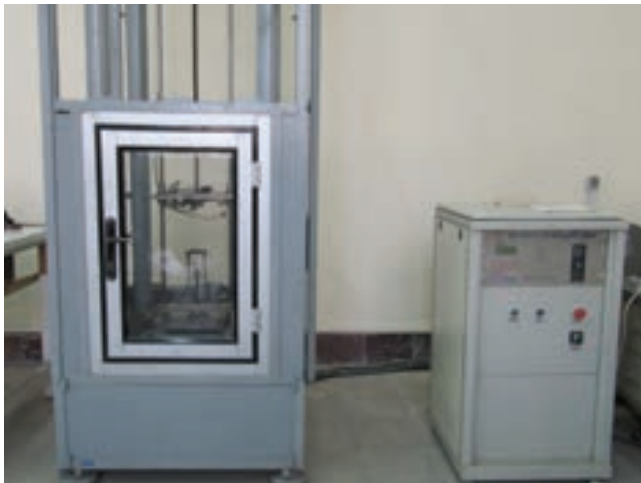
شکل ۳- نمایی از دستگاه سقوط آزاد ضربه.
