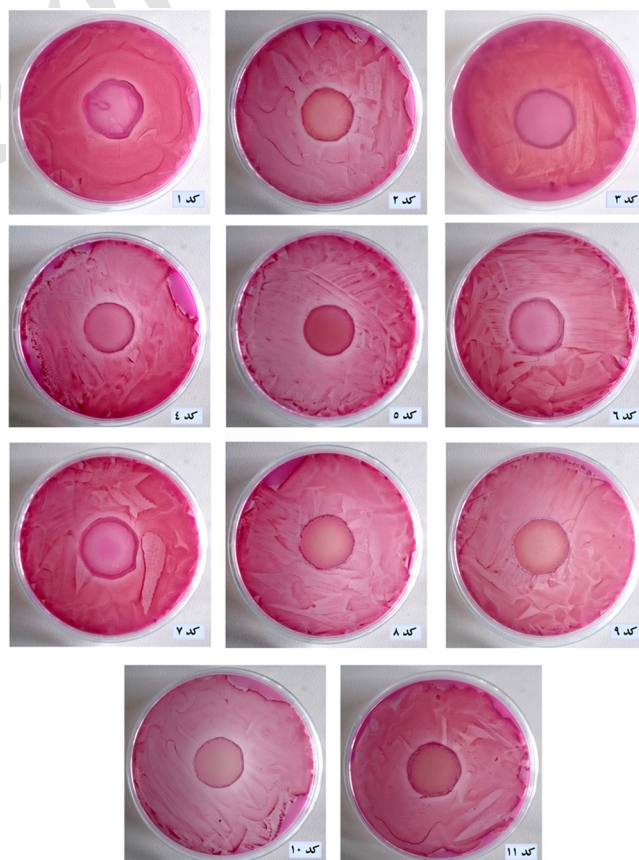
شکل ۱۰- تصاویر ناحیه بازدارنده انواع فیلم‌های نانوزیست کامپوزیت علیه باکتری اشرشیاکلی (کدها در تصاویر مطابق جدول ۱ است).
