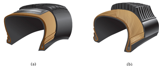
شکل ۱- قرارگیری الیاف در ساختار تایر: (a) رادیال و (b) اریبی [۹]. Fig. 1. Fiber placement in tire structure: (a) radial and (b) bias.
