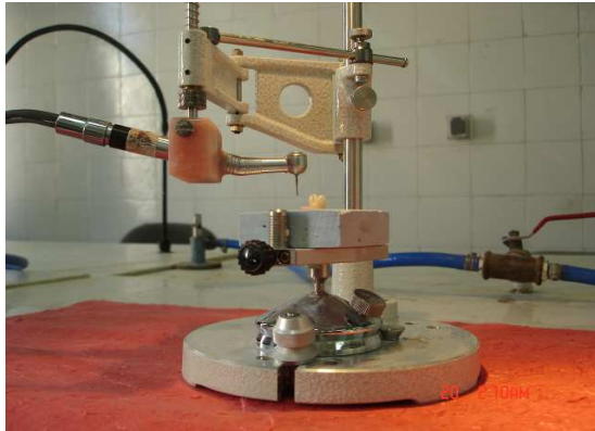
شکل ۱: نمونه‌ها روی دستگاه (SURVEYOR) آماده تراش
