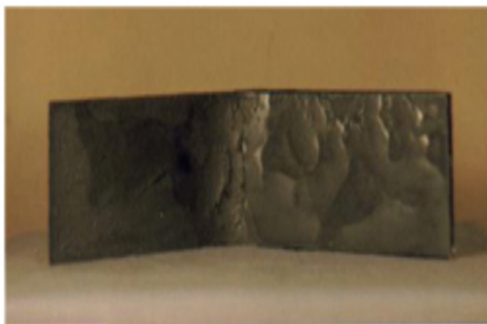
شکل ۴: نمونه خمش گرم فولاد B در دمای 1000^{\circ}\text{C} با زمان گرمایش ۹۰ دقیقه .
