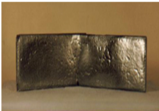
شکل ۱۰ : نمونه خمش گرم فولاد B در دمای °C ۱۲۰۰ با زمان گرمایش ۱۲۰ دقیقه .
