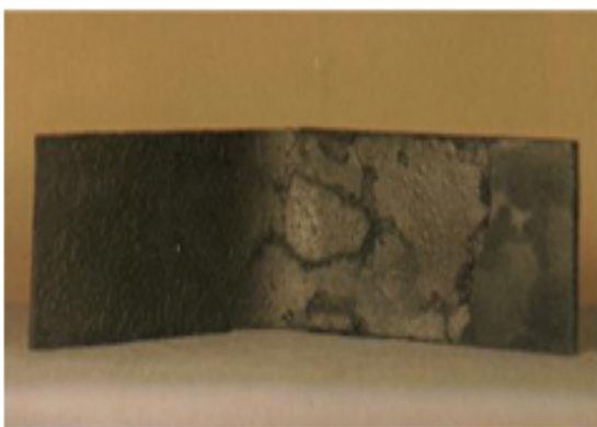
شکل ۶: نمونه خمش گرم فولاد B در دمای 1100^{\circ}\text{C} با زمان گرمایش ۹۰ دقیقه
