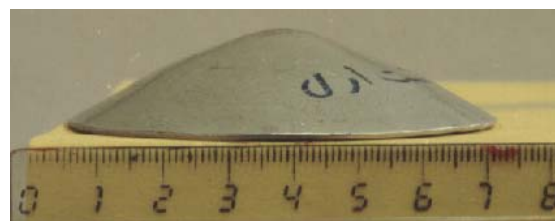
شکل ۱۱- پ: قطر قاعده مخروط کامل ۱۲۰ درجه منتج از تجربه برای گرده آلومینیمی به قطر ۸۰ و ضخامت ۱ میلیمتر.
