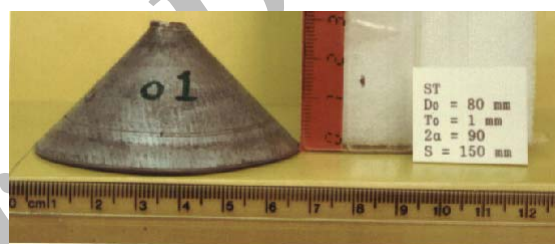
شکل ۱۱- ب: قطر قاعده مخروط کامل ۹۰ درجه منتج از تجربه برای گرده فولادی به قطر ۸۰ و ضخامت ۱ میلیمتر.
