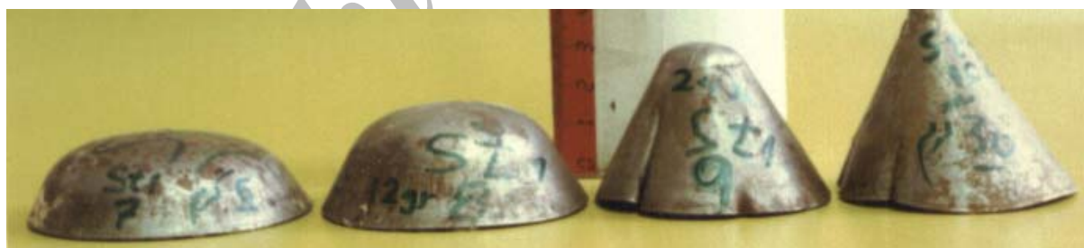
شکل ۴: پروفیل تغییر شکل ورق در جریان شکل دهی انفجاری مخروط منتج از تجربه.
