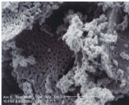
شکل ۲: SEM مربوط به کاتالیست LC.
