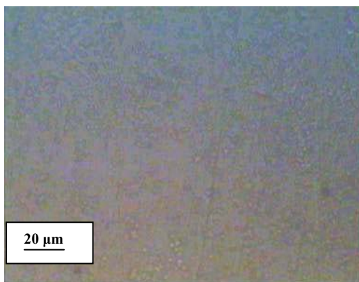
شکل ۵: تصویر میکروسکوپی از سطح ABS بدون آماده سازی (x500).
