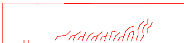
شکل ۱۳: شکل ترک خوردگی تحلیل عددی.
