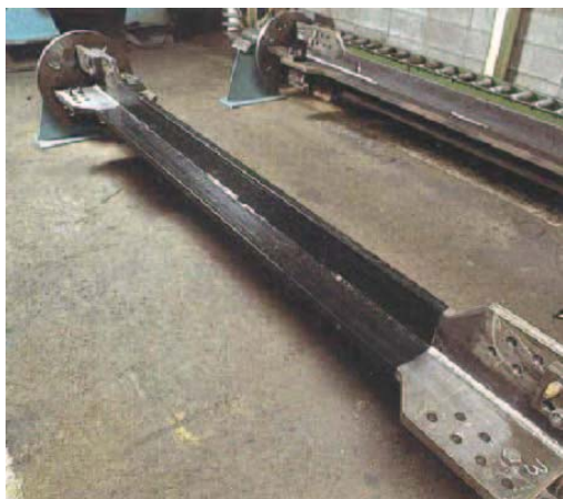
شکل ۲: هسته مرکزی با یک لایه لغزنده از بتن یا مصالح دیگر موجود در غلاف مجزا می شود. [۱۵].
