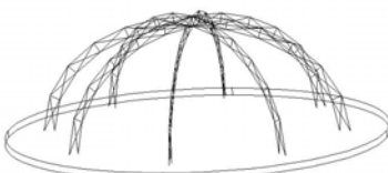
شکل ۲۵: سازه تاشوی گنبدی با قوس بیضی.
