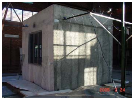
ب) نصب وسایل اندازه گیری بر روی نمونه بتن پاشی شده
