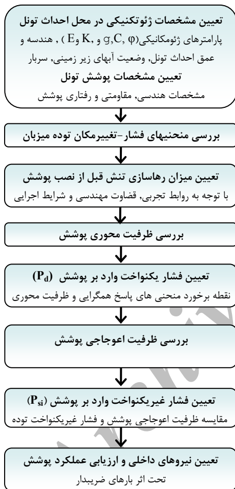
شکل ۳: مراحل ارزیابی پوشش تونل.
