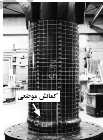
شکل ۳: خرابی برآمدگی پافیلی در ستون های لوله‌ای [۴].
