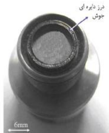
شکل ۱: نمونه جوش کاری شده فولاد شماره ۱.
