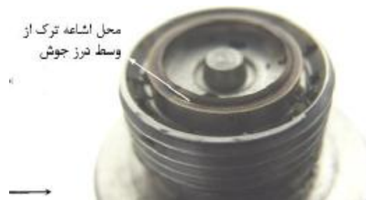
الف) تصویر نمونه ۴ نشست کرده
