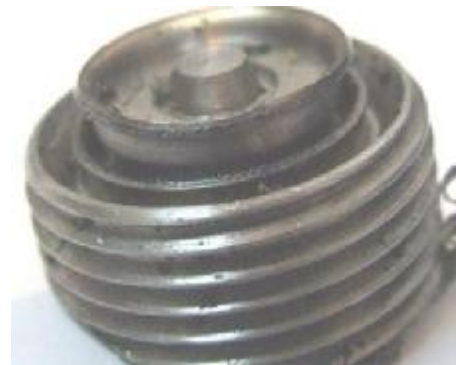
الف) تصویر نمونه ۵ نشست کرده
