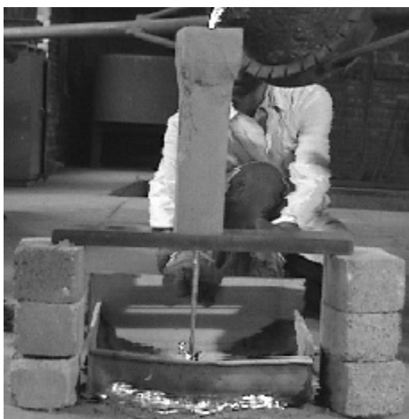
شکل ۵: آزمایش ۱، محاسبه سرعت حرکت مذاب در انتهای راهگاه بارریزی توسط اندازه گیری دبی خروجی جریان.
