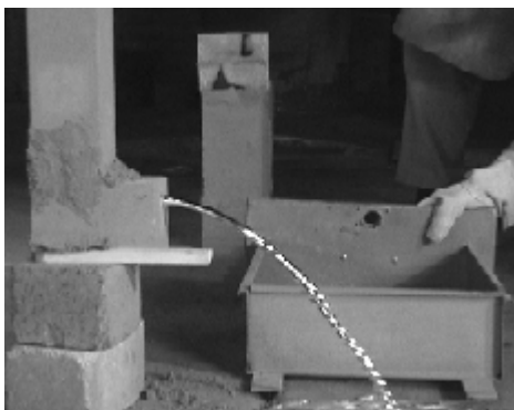
شکل ۶: آزمایش ۲، محاسبه سرعت حرکت مذاب در راهبار قبل از فیلتر توسط اندازه گیری دبی خروجی جریان.
