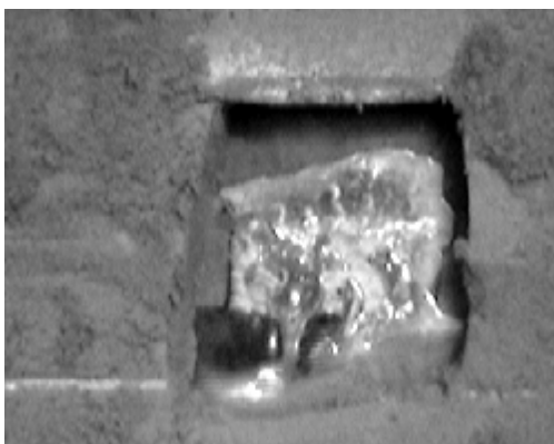
شکل ۱۱: چگونگی عبور مذاب از فیلتر اسفنجی در آزمایش ۳، بعد از تصحیح اندازه راهبار پس از فیلتر.
