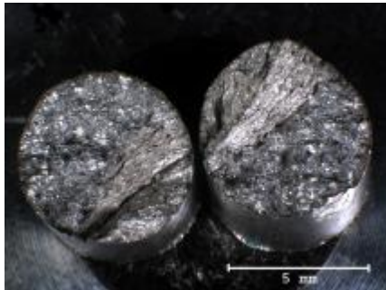
شکل ۳: سطح مقطع شکست دو نیمه یک نمونه آزمایش استحکام کششی از جنس Al-Si-Mg که دو لایه اکسید کاملاً متقارن را نشان می دهد [۸].
