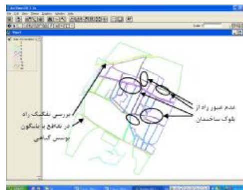
شکل ۱۰: فایل dxf عوارض رقومی شده راه و غیر راه در محیط نرم‌افزار ArcView و چند نمونه کنترل عوارض
