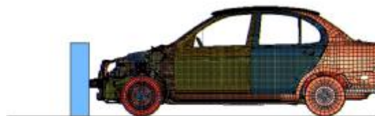
شکل ۱. مدل ساخته شده جهت تحلیل برخورد طولی.
