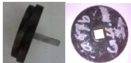
شکل ۹: آزمایش اکستروژن بیلت دایره‌ای به مقطع مربعی با استفاده از قالب همگرای دوخطی.
