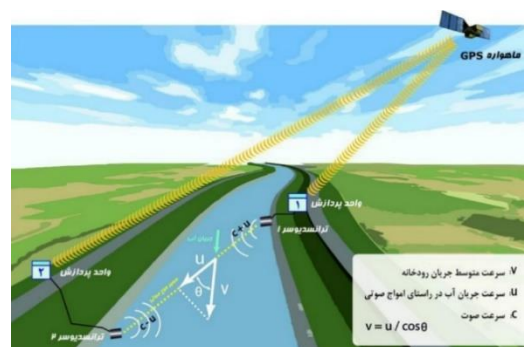
(شکل ۱- الگوی مفهومی سامانه تیکه‌نگاری صوتی [7]) (figure-1) Conceptual Pattern of Fluvial Acoustic Tomography System [7]
