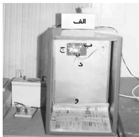
شکل ۱- سیستم آزمایشگاهی ویژه مولد امواج شبیه‌سازی شده تلفن‌های همراه ( 940\text{MHz} ) جهت بررسی این امواج بر باروری موش ماده نژاد Balb/C: (الف) منبع تغذیه، (ب) مولد فرکانس (VCD)، (ج) تقویت کننده، (د) آنتن، (و) اتاقت
