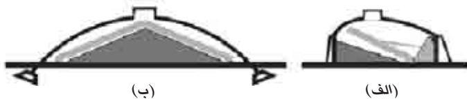
تصویر ۷- ارتباط بین فرم نوع عملکرد و سازه: (الف) نوار نقاله خود نگهدارنده، (ب) نوار نقاله نگهداشته شده توسط دیوار با جرتقیل با بازوی متحرک. ماخذ: (Falconer and Drury 1975)
