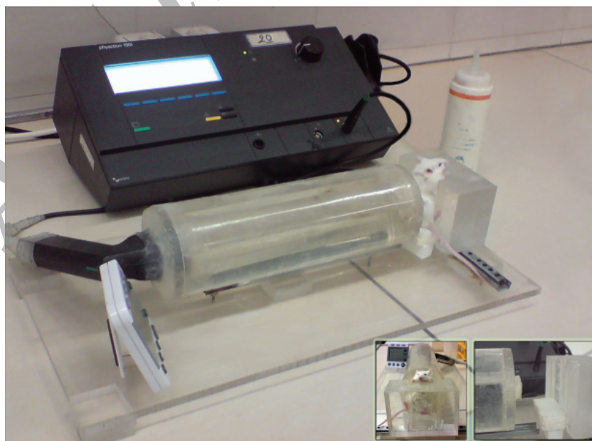
شکل ۱: دستگاه طراحی شده جهت موج‌دهی به موش، تصاویر کوچک سمت راست (پایین تصویر) وضعیت قرار گرفتن موش در دستگاه را نشان می‌دهد.
